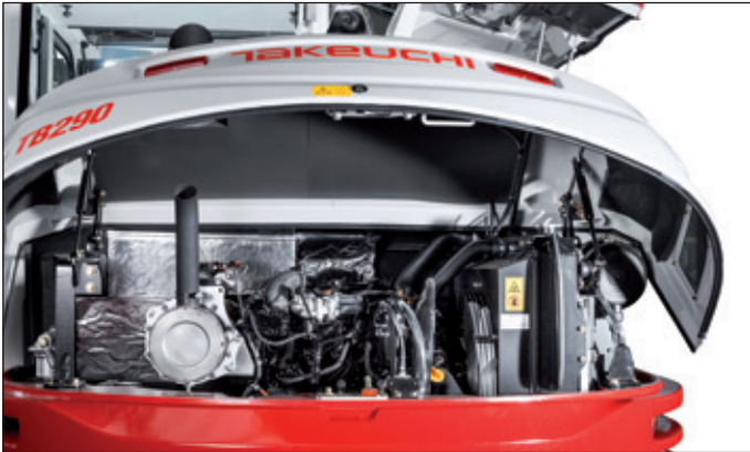
Verbrauchs-, abgas und lärmreduzierte Motorengeneration mit Zusatzaggregaten für minimalen Verbrauch und selbstregenerierendem Russpartikelfilter.
