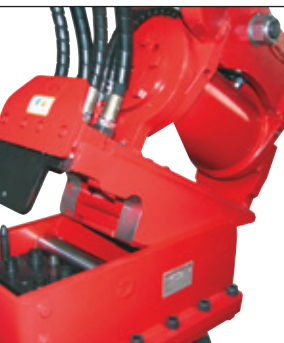
System Huppi-Quick: Hydraulikan-schlüsse werden beim Schnellwechselvorgang automatisch verbunden
