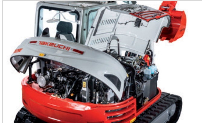
Großzügige Wartungsklappen für servicefreundlichen Zugang zu Motor und Hydraulikaggregaten.
