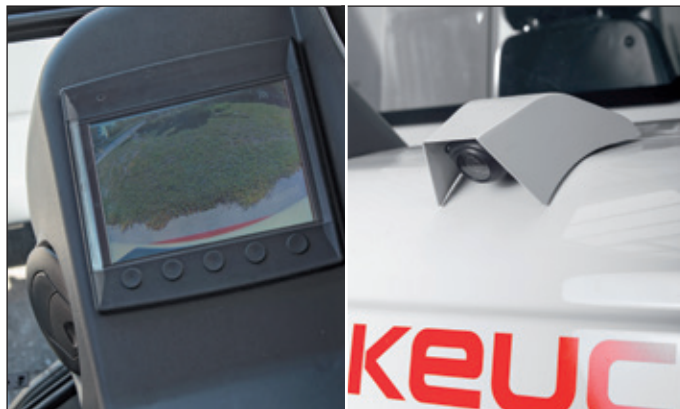
Übersichtliches Multifunktionsdisplay mit Einblendung der Rückfahrkamera. ECO-Modus zur Erhöhung der Wirtschaftlichkeit und Verringerung des Dieselverbrauchs.
