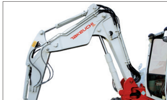
TB290 auch mit Verstellausleger erhältlich. 4 Steuerkreise, davon 3 proportional gesteuert, regulierbare Literleistung.
